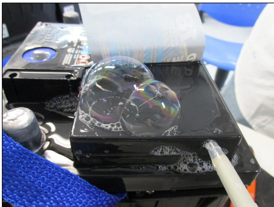
Figura B.1 Evidencia do ensaio de Estanqueidade: amostra LACCEL824 5-6.
